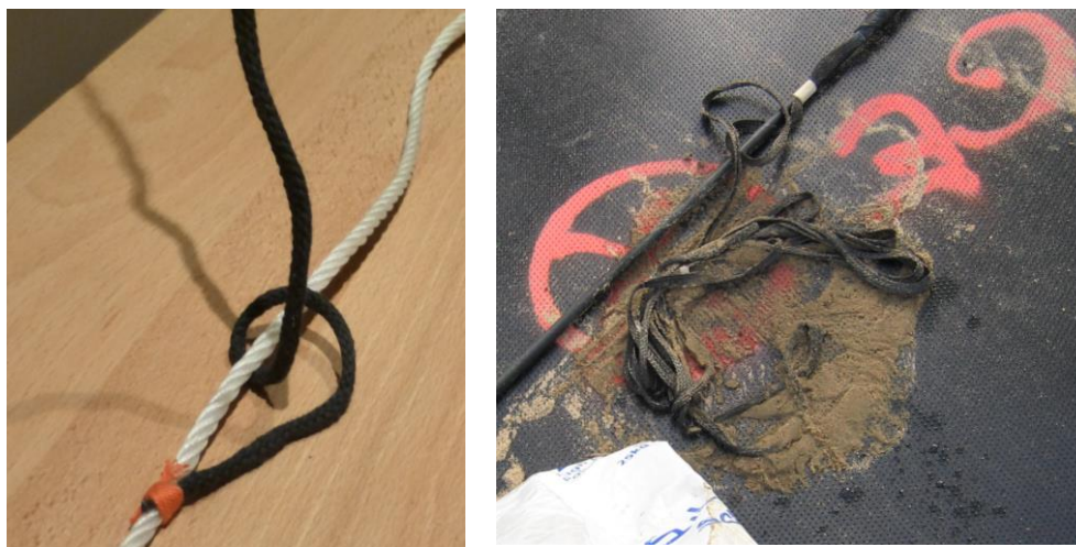
Figuur 2 links: Schematisch beeld van de signaalkabel (wit) op het folie (hier het keukenblad) met koppeling (oranje) daaraan van het carbonlint/sensor (zwart) die met een slinger om de signaalkabel naar boven (loodrecht op het folie) in de later aangebrachte grondlaag werd gevoerd (op de foto omhoog van het keukenblad).
